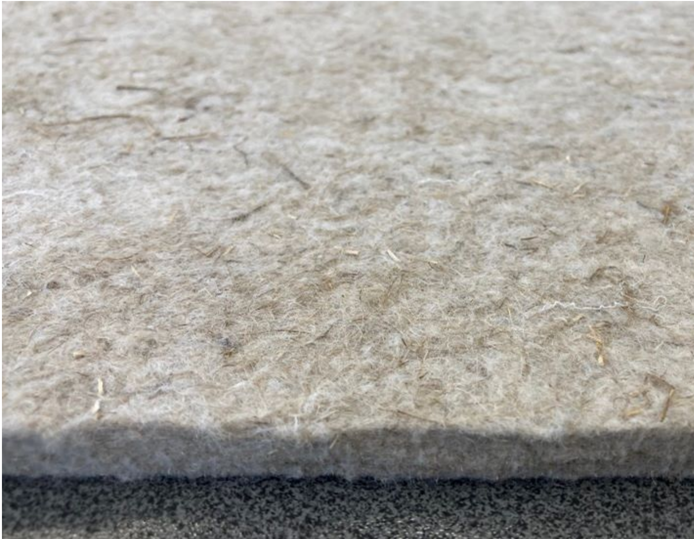
Figure 6 : exemple de tapis non tissé dans lequel les fibres naturelles et les fibres polymères ont été préalablement mélangées
