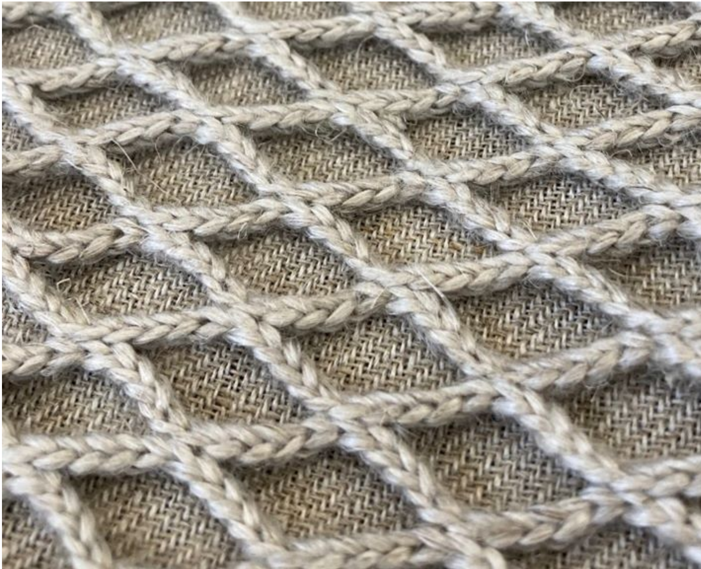
Figure 11 : combinaison de tissu de lin et de filet de lin comme matériau de départ pour le plateau sans motif de trous
