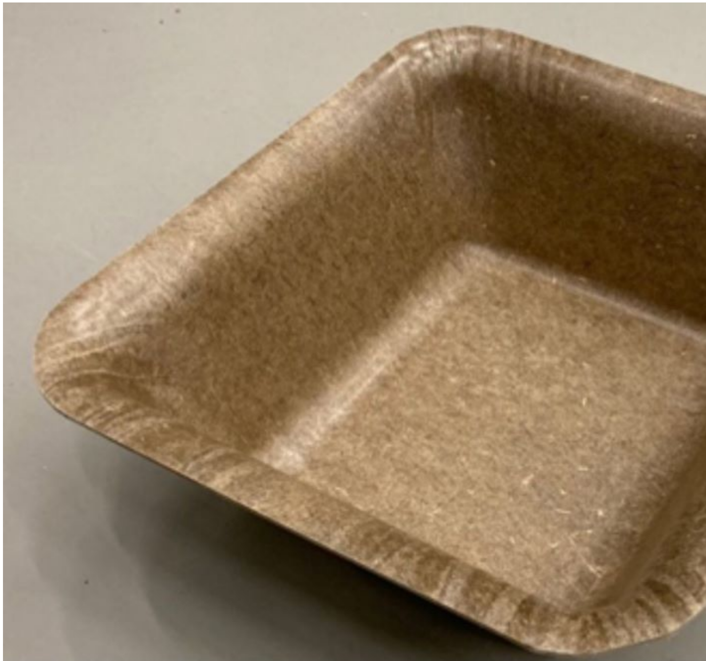
Figure 8 : la cuvette et le coffret en PLA-lin et PP-chanvre, résultat final du démonstrateur de coffret
