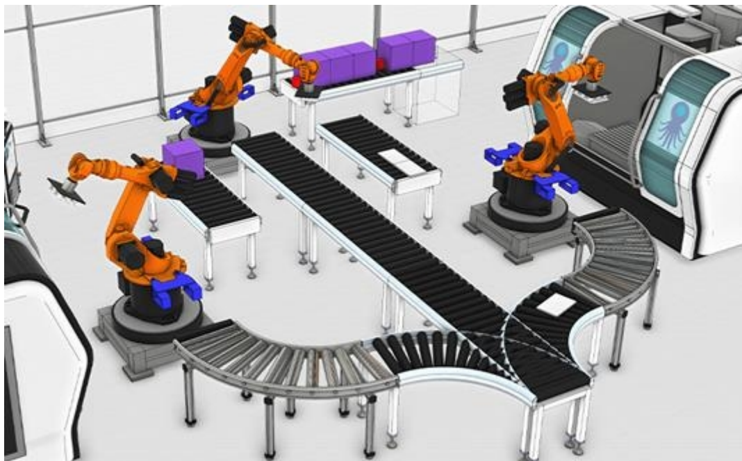
Afbeelding 4: Octopuz OLRP – in de simulatie kunnen meerdere robots en zelfs CNC-machines worden gemanipuleerd. De software helpt u de cyclustijd en andere nuttige productiestatistieken te berekenen.
