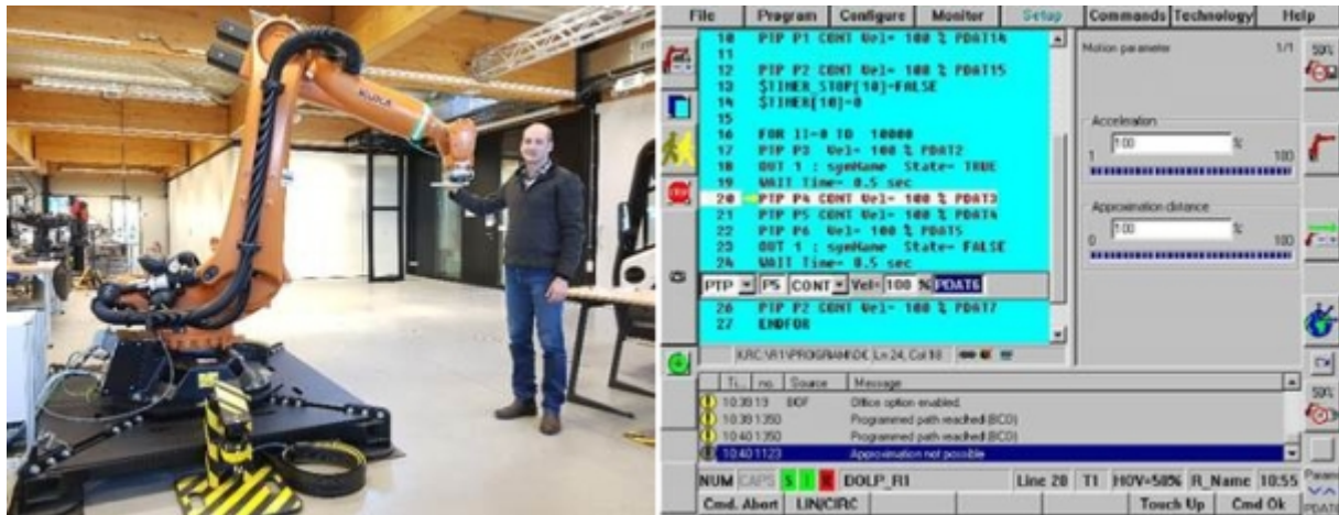
Afbeelding 1: KUKA manueel geleidesysteem bij Sirris (links); KUKA interface met bedieningsapparaat en voorbeeld van een programma (rechts)
