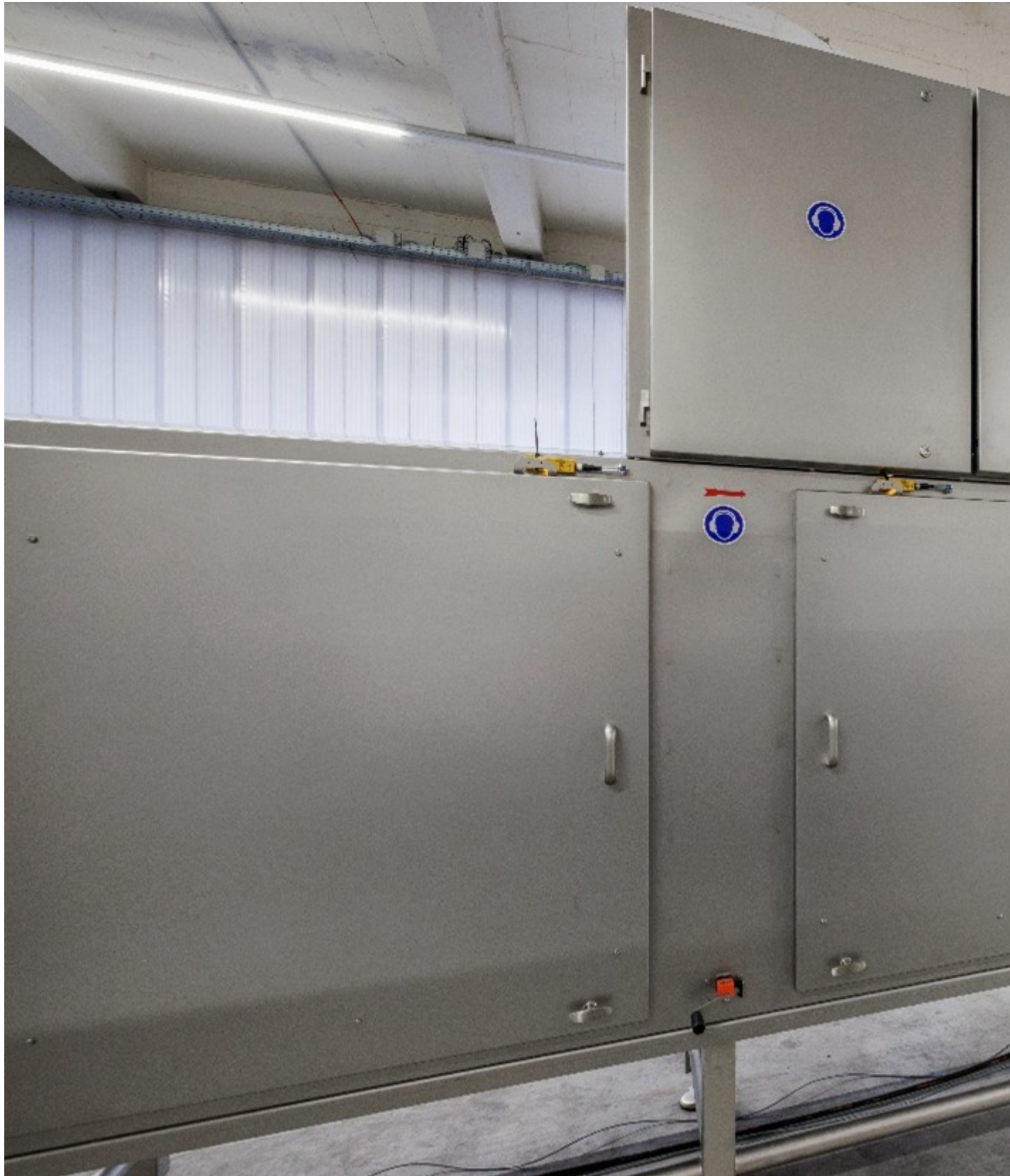
Ronair machine van CYAGO toegepast op het drogen van flacons en gebaseerd op energie-efficiënte ventilatortechnologie in de plaats van perslucht.
