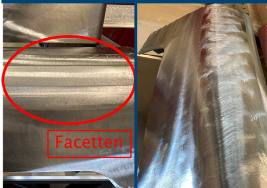
Stap 1: Wegslijpen van laspunten met Scotch Brite Grinding & Blending (getest horizontaal en verticaal)
