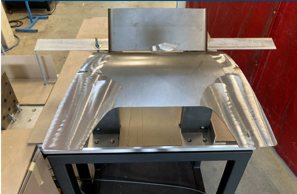
Stap 1: Wegslijpen van laspunten met Cubitron
