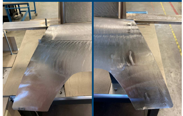
Stap 2: Finishing met orbitaal schuurmachine
